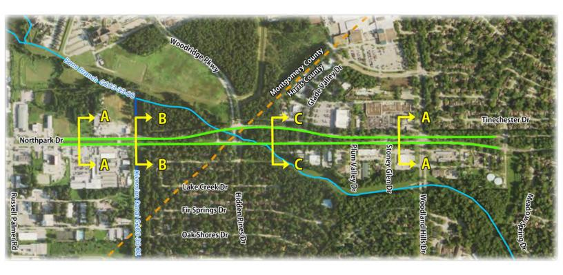
El diseño actual de Northpark Drive puede dividirse en distintas secciones. Las diferentes configuraciones de estas secciones se ilustran mediante secciones tipo, que son cortes transversales del aspecto actual de la carretera.
