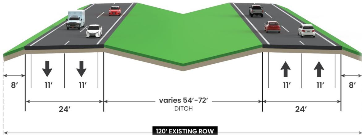
La sección típica existente A tiene actualmente cuatro carriles de circulación de 11 pies de ancho, con una mediana de zanja de césped de anchura variable entre 54 y 72 pies de ancho. El derecho de vía (ROW) existente tiene una anchura aproximada de 120 pies.
